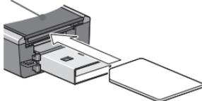
キャップを取り外し、USIMカードをUSIMカードスロットに、カチッと音がするまでゆっくり奥に差し込みます。取り外すときは、USIMカードを軽く押し込みます。USIMカードスロットからUSIMカードが出てくるので、ゆっくり取り出してください。
