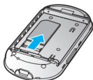
5. USIM カードを矢印方向に引いて、USIM カードスロットから取り外します。
