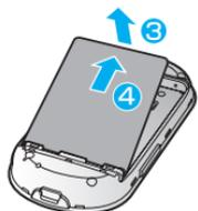
4. 電池パックを3の方向へ持ち上げて、4の方向へ取り外します。
