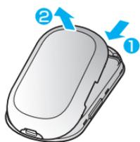
3. 電池カバーロック解除ボタンを押して (1)、電池カバーを取り外します (2)。
