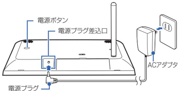
**1** 付属のACアダプタの電源プラグを、本機底面の電源プラグ差込口に差し込む
