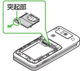
**③ USIMカードを少し持ち上げながらスライドして取り外す**
