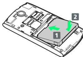
・電池パックと本機の金属端子が合うように **1** の方向に差し込んでから、**2** の方向にはめ込みます。
