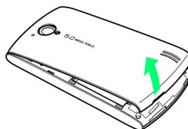
・ディスプレイが下向き状態で、本体のくぼみから電池カバーを持ち上げて取り外します。
