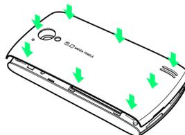
・電池カバーと本体の間にすきまができないよう「カチッ」と音がするまで押し込んで、完全に閉めます。
