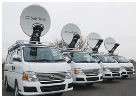
可搬型移動基地局
