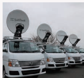
可搬型移動基地局
