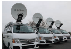
可搬型移動基地局
