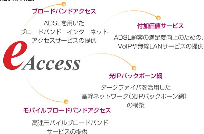
(注) ADSL(Asymmetric Digital Subscriber Line): DSLの方式の一種であり、Asymmetric(非対称)という名前が示すとおり、上り(ユーザーPC→インターネット)と下り(インターネット→ユーザーPC)の通信速度が非対称であることを特徴とする。例えば当社の50Mbps ADSLサービスでは上り最大通信速度が5Mbps、下り最大通信速度が50Mbpsとなり、これはISDN回線(64Kbps)と比較して下りにおいては最大781倍の速度に相当する。
