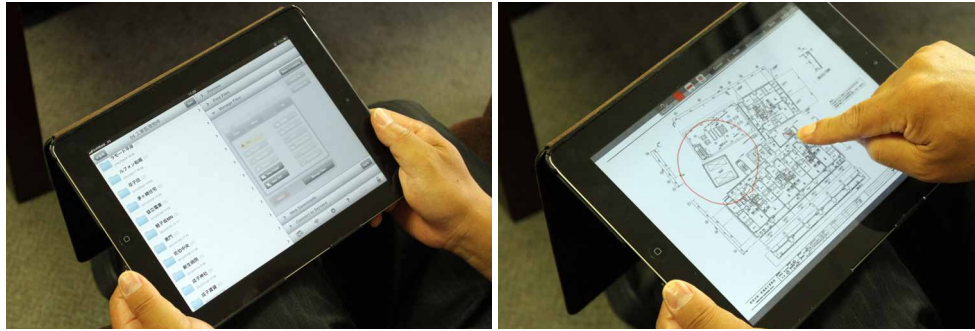
「GoodReader」のファイル管理機能を使ってすべての物件ごとにフォルダ分けして電子図面を格納（左）、図面上にメモやコメントの書き込みが可能だ（右）
