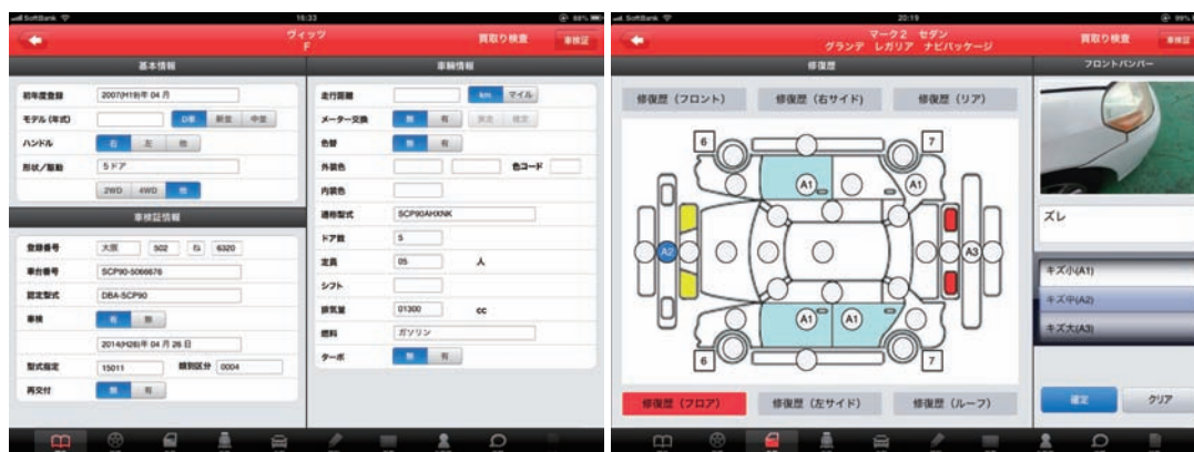
買取査定アプリ「FIT」(Flex Used Car Inspection terminal)の操作画面。車検証のQRコードから読み取った諸元(左)、外観のチェック箇所には写真も貼り付けられる(右)
