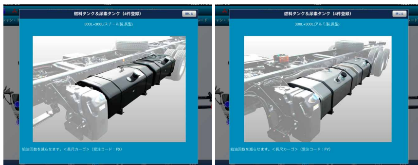
燃料タンクのオプションを比較できる機能（左がスチール製、右がアルミ製）。フリック操作で簡単に両者の違いを視覚的に確認できる
