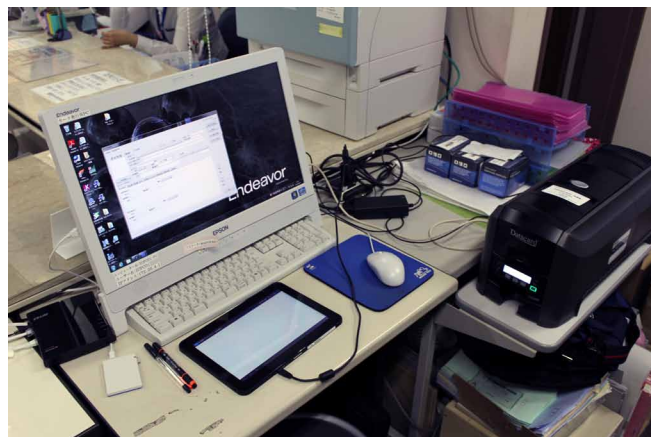
同院の窓口に用意されたICカード発行機。タブレット端末で患者の写真を撮り、その場で顔写真入りのICカードを発行できる。書き込まれる患者情報は電子カルテシステムと連動している
