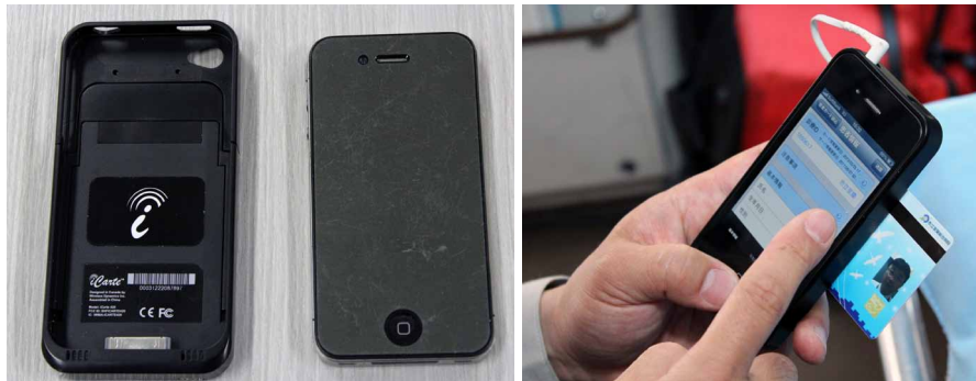
iPhoneとカバー型の専用ICカードリーダー（左）、ICカードをiPhoneに接触させると患者情報が表示される（右）
