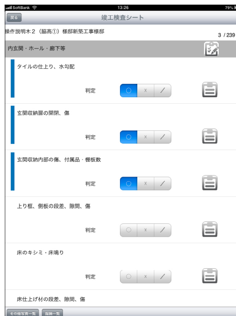
「かん助」の操作画面。項目ごとに○×を選択していくことで帳票を完成させる
