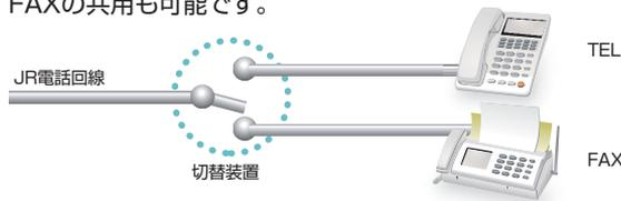
1台の電話機またはFAXをJR電話サービス回線とNTT電話回線に切替えてご利用いただけます。
