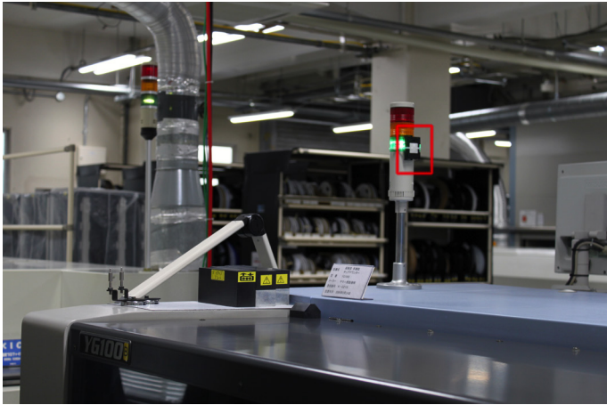
工作機器のパトライトに設置されたセンサー
