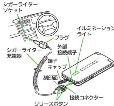
**1 外部接続端子の端子キャップを開く (☞P.1-5)****2 シガーライター充電器の接続コネクターを本機に差し込む**
