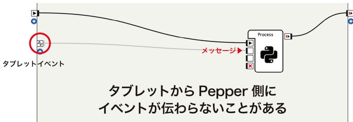
次に示すフローダイアグラムのように、一定時間待った後もディスプレイからイベントが来ない場合、ロボアプリが進行できるようにします。正常にイベントを受信できた場合はタイムアウトタイマーを停止させてください。
