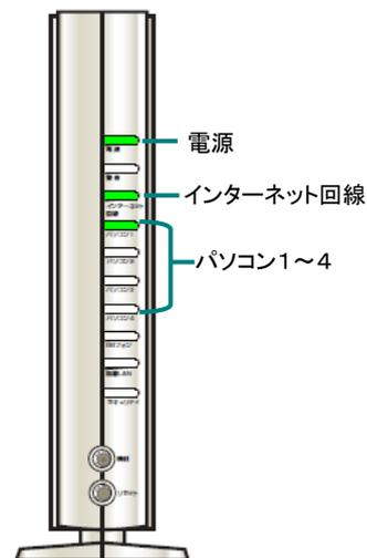
6) フェムトセル機器のランプが、通常稼働状態になるのを確認します。
